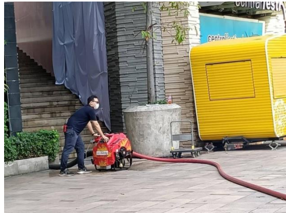
รูปที่ 42 ทดสอบการทำงานของเครื่องสูบน้ำ
